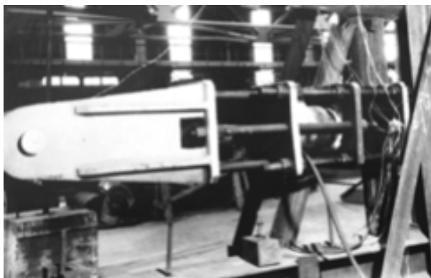
Рис. 7. Вигляд домкрата ДГМ-200 в реверсорі для створення в рамі повздовжнього навантаження
