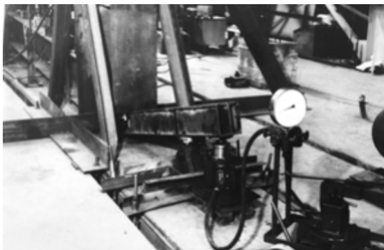
Рис. 8. Передача зосередженого вітрового навантаження домкратом ДГМ-25 через важіль
