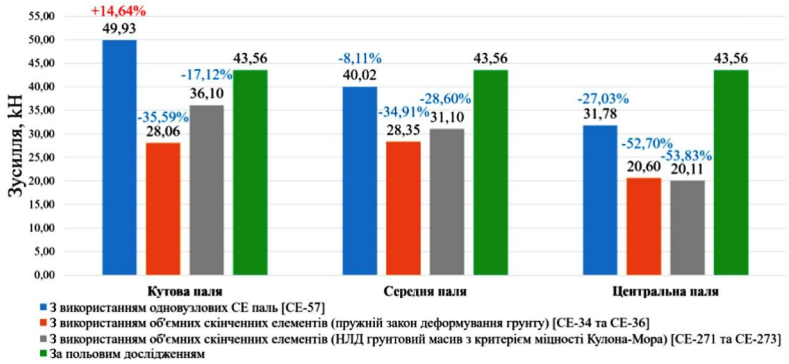
Рис. 6. Порівняння поздовжніх зусиль у характерних палях на першій стадії навантаження (400 кН)
