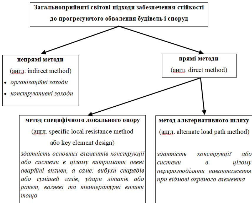
Рис. 1. Схема загальноприйнятних світових підходів забезпечення стійкості до прогресуючого обвалення будівель і споруд
