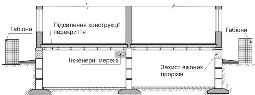
Рис. 3. Укриття в підвальному приміщенні цегляних будинків з перекриттям круглопустотними залізобетонними плитами
