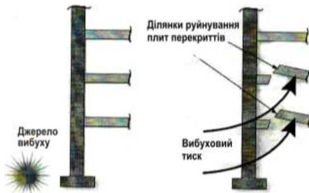
Рис. 4. Можливі руйнування плит перекриттів в результаті направлення вибухового тиску вгору
