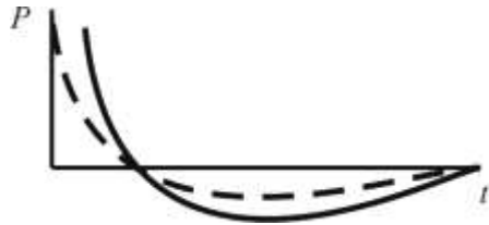
Рис. 1. Розподіл тиску ударної хвилі на конструкції будівлі у часі ( t ) при наближеному фронті ударної хвилі (суцільна крива) і при віддаленому фронті ударної хвилі (пунктирна крива)
