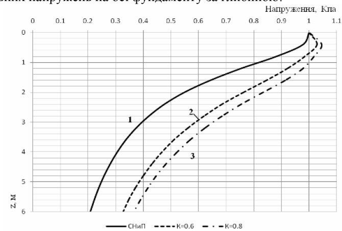
Рис. 3. Епюри розподілу вертикальних напружень по осі фундаменту: 1 - в суцільній основі, 2, 3 - в пористій основі, при коефіцієнті пористості відповідно 0.6; 0.8
