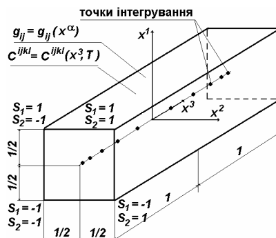
Рис. 4. Неоднорідні круговий і призматичний скінчені елементи із змінними геометричними і фізичними параметрами і довільними граничними умовами в місцевій системі координат
