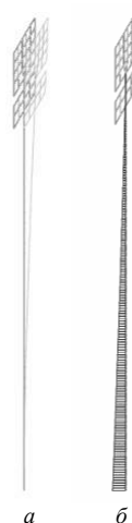
Рис. 4. Розрахунок пілона на сумісну дію статичної та пульсаційної складових вітрового навантаження: а) еюра прогинів, б) еюра згинальних моментів
