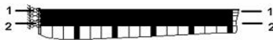
Рис. 5. Розміщення характерних перерізів для побудови графіків розподілення згинальних напружень по довжині фрагмента плити
