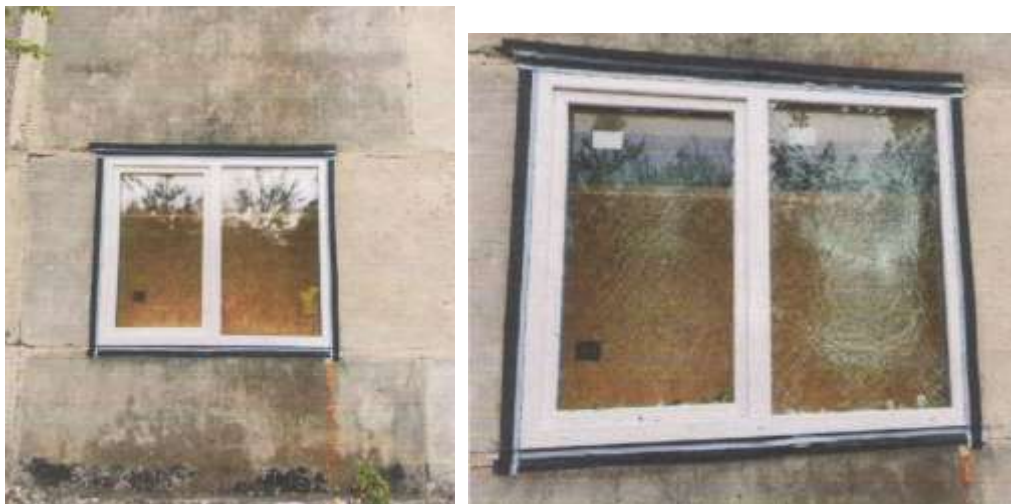
Рис. 4. Віконна конструкція зразка №S2-02_2023 до (ліворуч) та після (праворуч) випробування [8]
