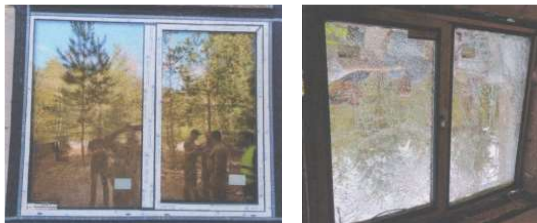
Рис. 6. Віконна конструкція зразка №S3-02_2023 до (ліворуч) та після (праворуч) випробування [6]
