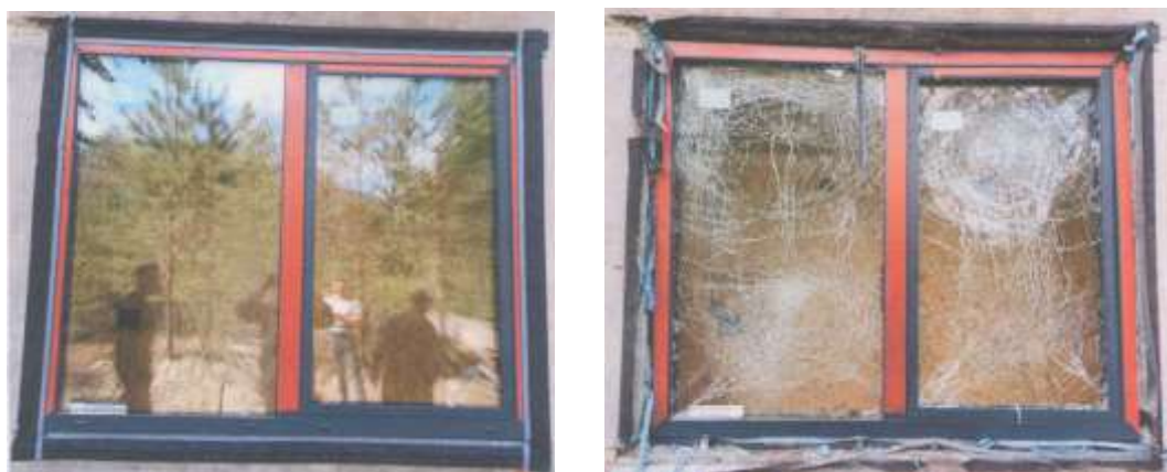
Рис. 5. Віконна конструкція зразка №S3-01_2023 до (ліворуч) та після (праворуч) випробування [6]
