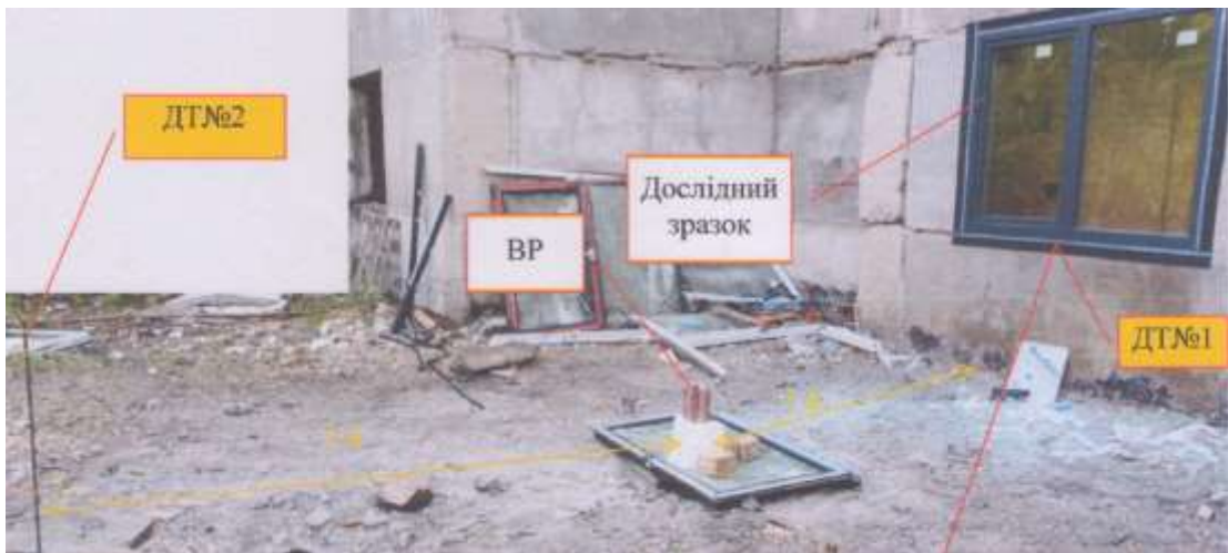
Рис. 2. Схема встановлення вимірювального обладнання [7]
