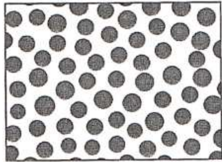
Рис. 1. Ілюстрація розрізу композиту із алюмінію і кварцового волокна (діаметр волокна 50 мкм)
